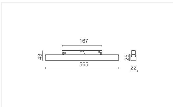
Luminaire allongé très design, équipé d'un strip LED offrant une répartition de lumière uniforme. Equipé d'un adaptateur 48V pouvant être inséré facilement dans les rails magnétiques LA VILLA 48.
