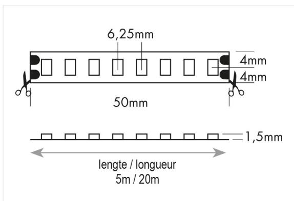
**10 lm/m 24V IP20 CCT 4000K 1400 lm/m IRC 90**
