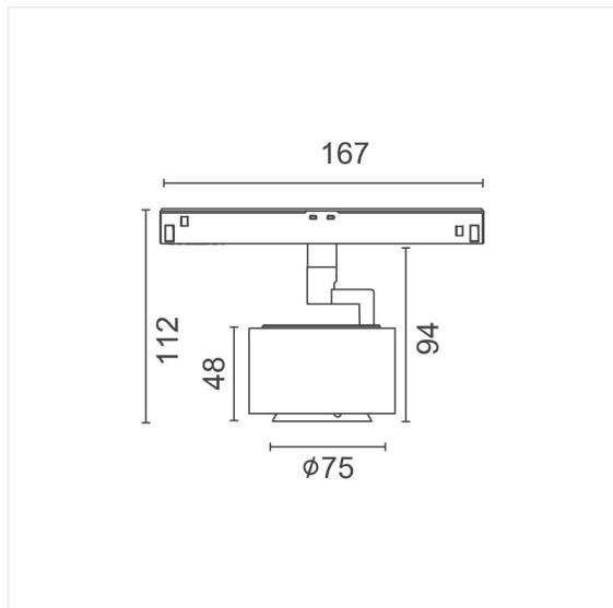
Module spot à faisceau lumineux très puissant, équipé d'un adaptateur 48 V pouvant être inséré facilement dans les rails magnétiques LA VILLA 48. Le spot peut être tourné et incliné pour orienter la lumière dans toutes les directions.
