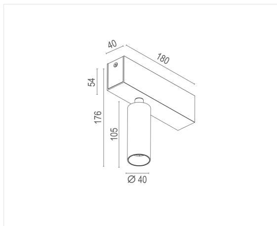
Anbauleuchte für Decke oder Wand mit drehbarem Spot-Modul, komplett mit dimmbarem Treiber im Gehäuse. Das Spotmodul kann in jede Richtung gedreht und gekippt werden. Mattweiße oder schwarze Farbe.
