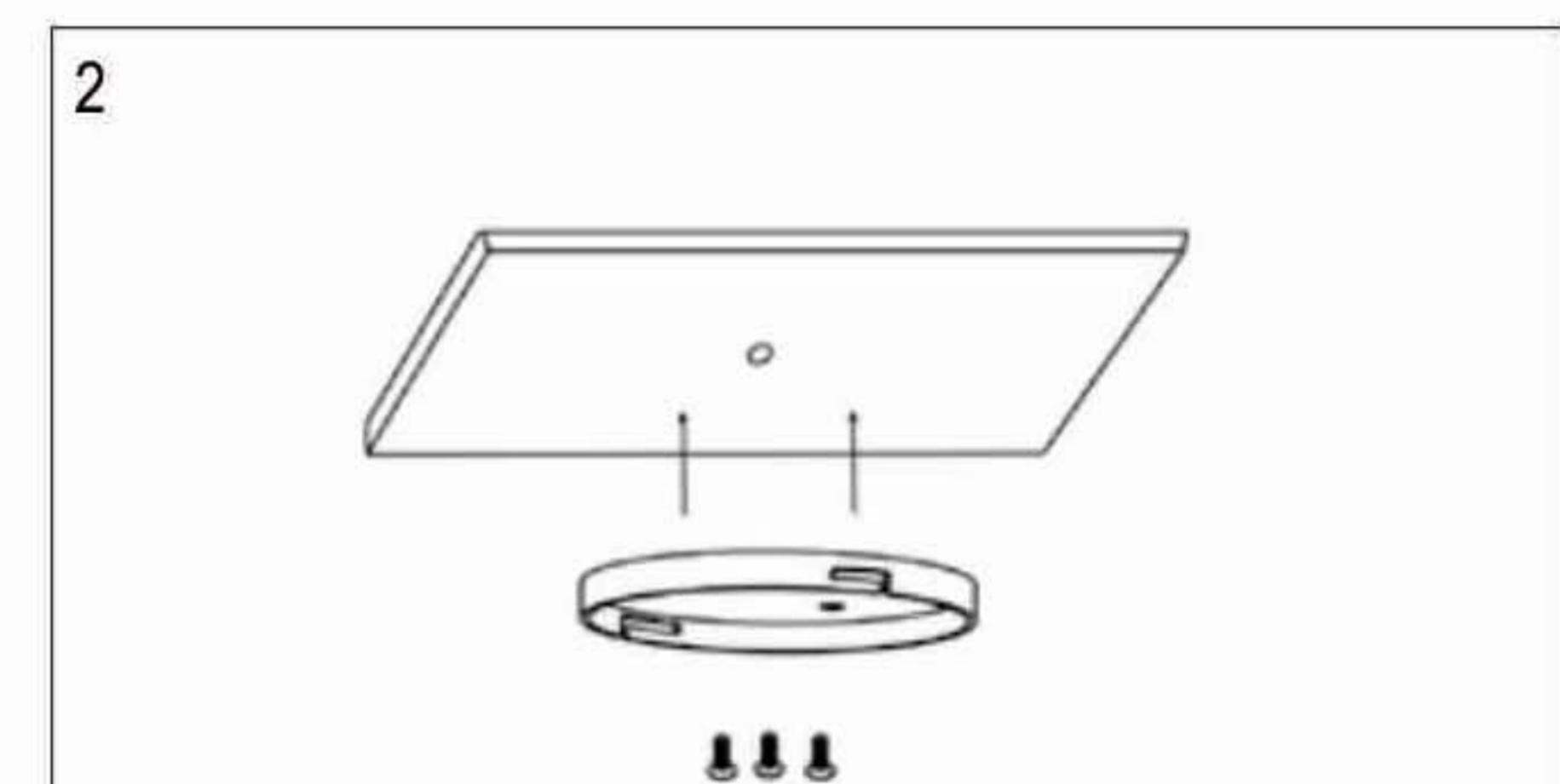
Bevestig de plafondplaat met 3 schroeven. Verbindt de voedingskabel.
