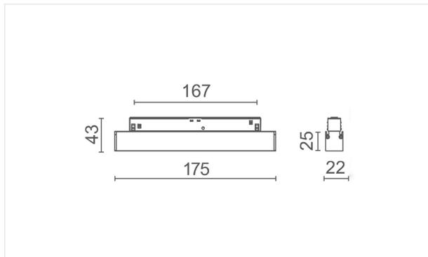
Längliche Designleuchte mit 5 leistungsstarken OSRAM-LEDs, platziert in einem kompakten Reflektor. Erzeugt einen hervorragenden blendfreien starken Lichtstrahl. Ausgestattet mit einem 48V Adapter, welcher mühelos an einer beliebigen Stelle in die LA VILLA 48 Magnetschiene eingeklickt werden kann.
